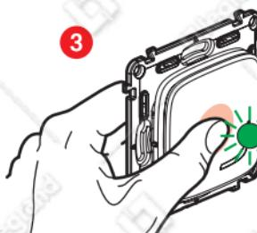
**Кратковременно нажмите** на каждый дополнительный беспроводной выключатель, чтобы активировать его. Индикатор замигает зеленым светом, затем начнет гореть ровно оранжевым светом и потом погаснет.
