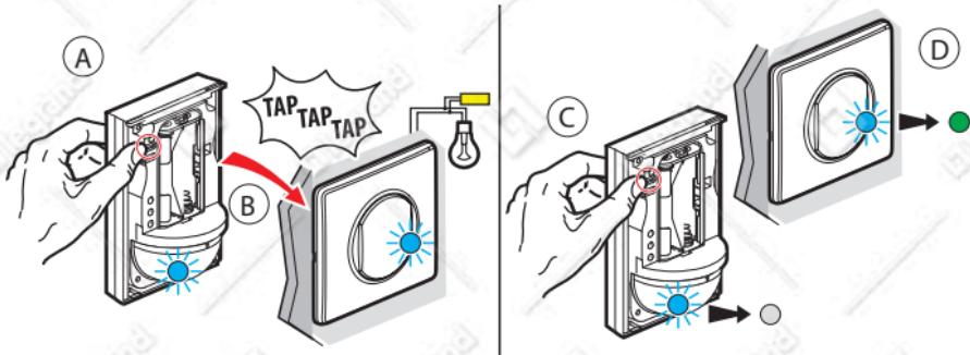
Шаг А: Удерживая нажатой кнопку ON умного беспроводного датчика движения, постучите 3 раза датчиком по умному проводному выключателю, которым вы хотите управлять.
