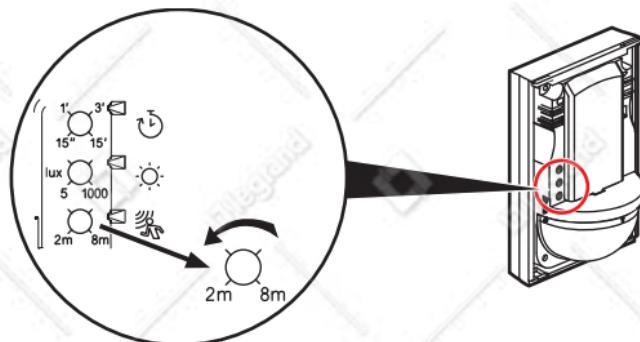
Для уменьшения чувствительности датчика, поверните потенциометр против часовой стрелки. Плое действия датчика уменьшится.
