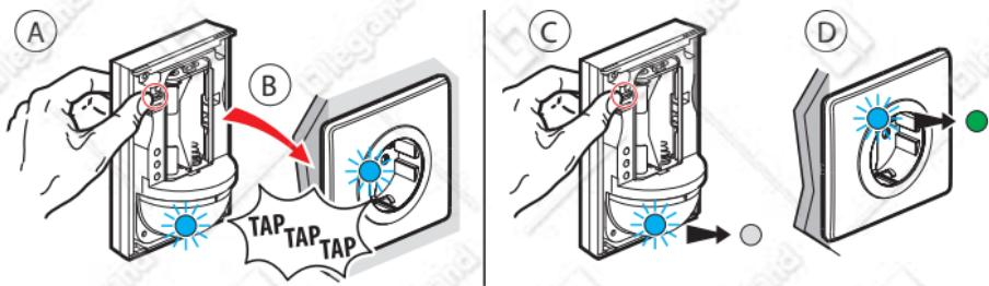
Шаг А: Удерживая нажатой кнопку ON умного беспроводного датчика движения, постучите 3 раза датчиком по умной розетке, которой вы хотите управлять.
