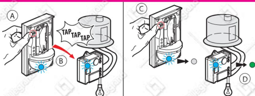
Шаг А: Удерживая нажатой кнопку ON умного беспроводного датчика движения, постучите 3 раза датчиком по умному микромодулю, которым вы хотите управлять.
